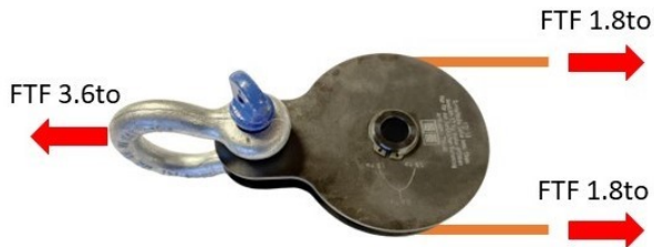
Fig. 7 : forces agissant sur une poulie de renvoi simple
