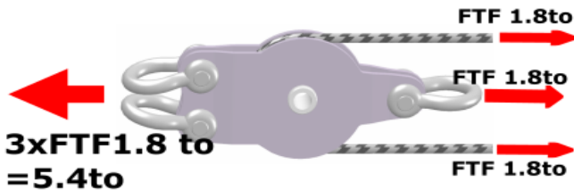
Obr. 1: Sily pôsobiace na jednoduchú vodiacu kladku
