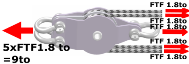
Fig. 2: Virkende krefter på dobbelt omløpstrinse
