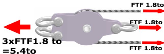
Fig. 1: forces agissant sur une poulie de renvoi simple
