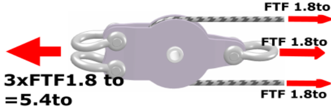
Bild 1: Krafter som verkar på en enkel omlänkingsrulle
