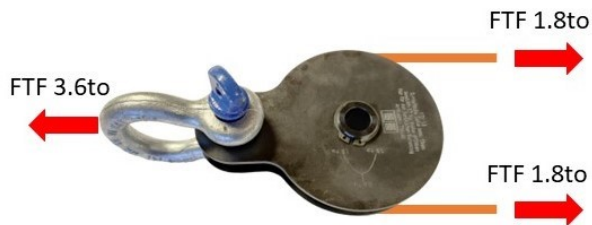
Abb.7: wirkende Kräfte an 1-fach Umlenkrolle
