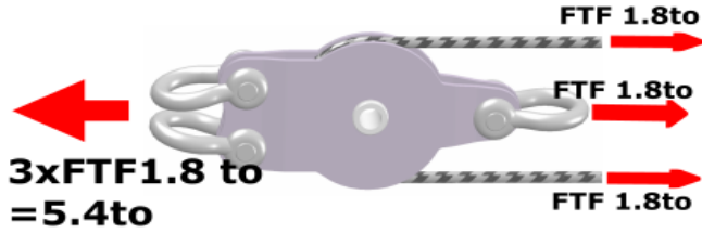
Fig. 1: Virkende krefter på enkel omløpstrinse
