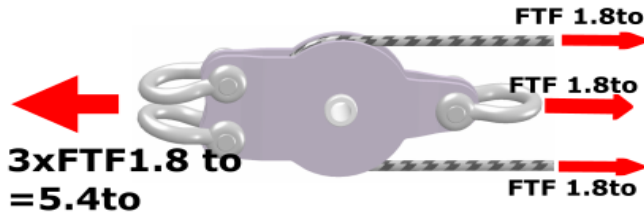
Abb. 1: wirkende Kräfte an 1-fach Umlenkrolle
