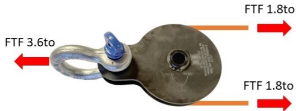
Bild 7: Krafter som verkar på en enkel omlänkningsrulle
