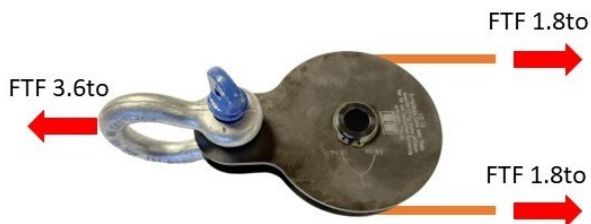
Obr. 7: Síly působící na jednoduchou vratnou kladku
