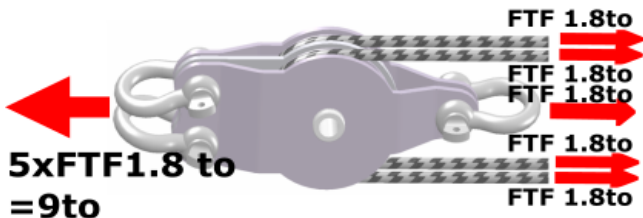
Obr. 2: Síly působící na dvojitou vratnou kladku
